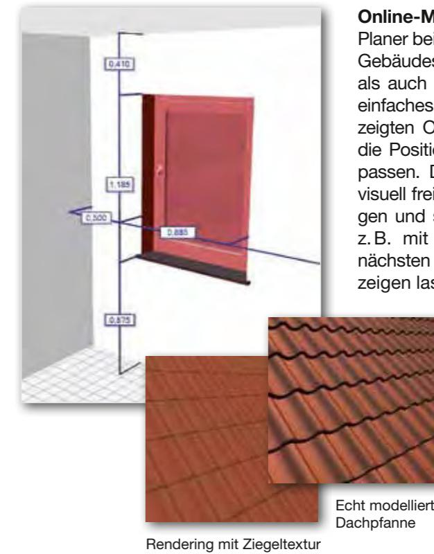
**Online-Maße** unterstützen den Planer bei der Konstruktion des Gebäudes sowohl im Grundriss als auch im 3D-Modell. Durch einfaches Verändern der angezeigten Objektmaße lässt sich die Position eines Bauteils anpassen. Der Planer kann sich visuell frei im 3D-Modell bewegen und sich die Objektmaße, z.B. mit den Abständen zur nächsten Wand, sichtbar anzeigen lassen.
